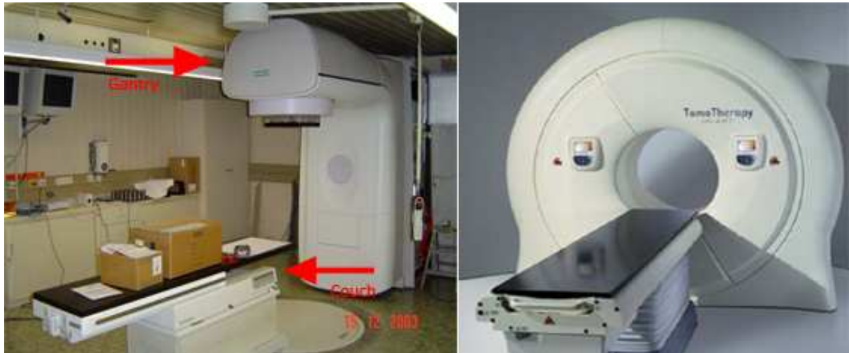
Abbildung 1: Links ist ein Elektronen-Linearbeschleuniger abgebildet und rechts eine Tomotherapie-Gerät, welches auf dem gleichen Prinzip beruht, aber weniger Freiheitsgrade besitzt, dafür aber auch als CT fungieren kann [Ben11].
