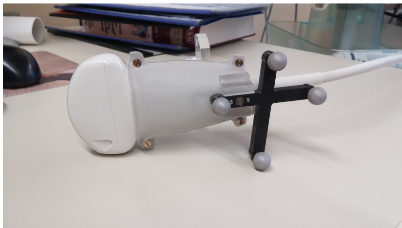
Abbildung 3.2: Die Ultraschallkopf-Halterung mit montiertem Ultraschallkopf. Man erkennt den Rigid-Body mit seinen 4 Marker Kugeln
