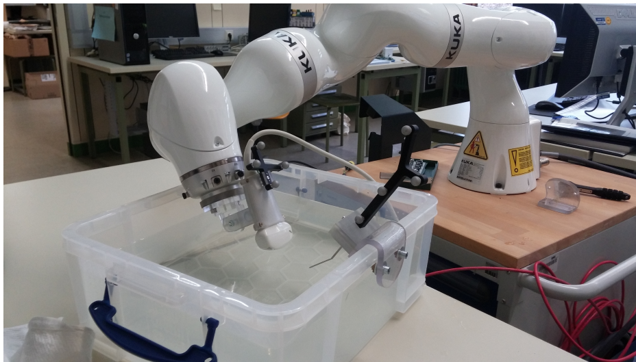
Abbildung 3.4: Versuchsaufbau Nr. 1. Man erkennt das Wasserbad, den Pointer, die US-Halterung mit Rigid Body und den KUKA-Roboter
