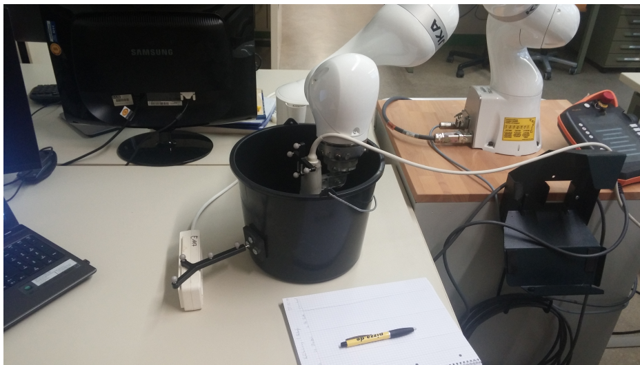
Abbildung 3.5: Versuchsaufbau Nr. 2. Prinzipiell wie der Aufbau vom Versuch Nr. 1, nur das Wasserbad wurde ausgetauscht
