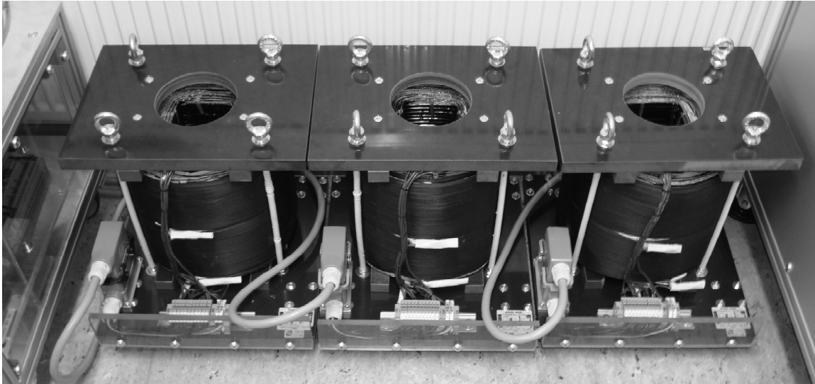
Abb. 35 Luftspulen zur Nachbildung der drei Stranginduktivitäten L_{dq} des AME
