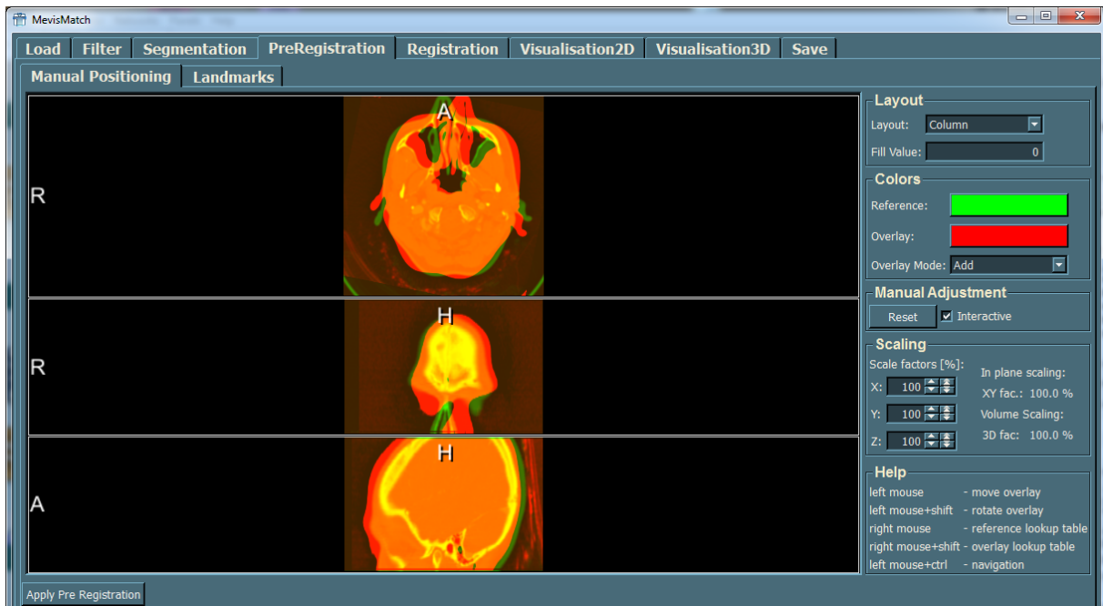
Abbildung 53: Tab für die Registrierungsvorbereitung. Unter PreRegistration kann der Objektdatensatz manuell auf den Referenzdatensatz ausgerichtet werden.
