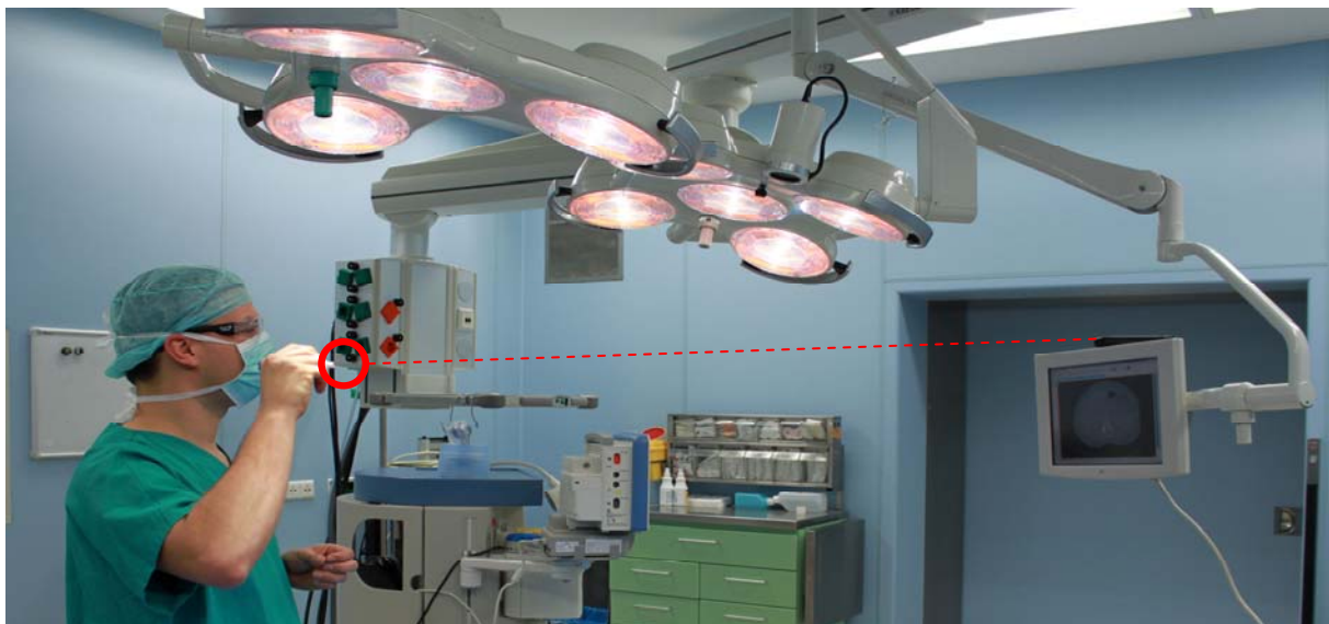
Abbildung 3.14: Scrollen durch transversale Schichtbilder im OP mit rot markierten IR Sender und Strahlenverlauf zur IR Kamera
